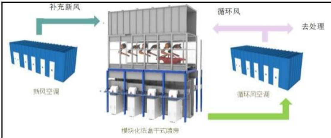
图5.2-1 干式喷漆室工艺流程图
